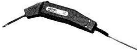
Fig. 6 - Modello di saldatore elettrico istantaneo leggerissimo ideale per i piccoli componenti elettronici.
