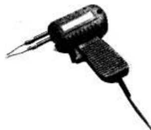
Fig. 5 - Il saldatore istantaneo a pistola per saldature rapide e saltuarie, 1
